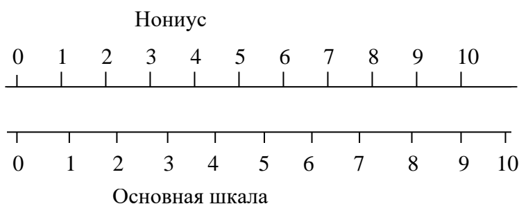
Рисунок 2.1 – Нониус и основная шкала
