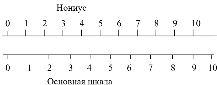
Рисунок 2.1 – Нониус и основная шкала
