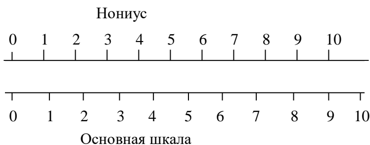
Рисунок 2.1 – Нониус и основная шкала
