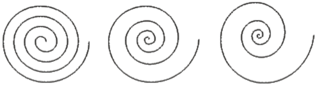
Рисунок 2.6 Четырехвитковые спирали. Слева – симметричная, справа – логарифмические с коэффициентами расширения 50 и 100 %
