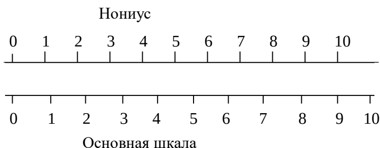
Рисунок 2.1 – Нониус и основная шкала
