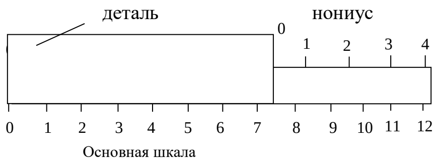
Рисунок 2.2 – Схема измерения детали
