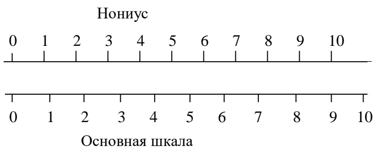
Рисунок 2.1 – Нониус и основная шкала
