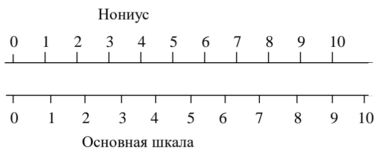
Рисунок 2.1 – Нониус и основная шкала
