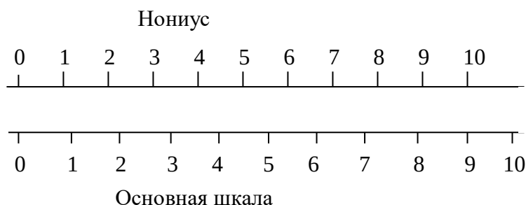
Рисунок 2.1 – Нониус и основная шкала
