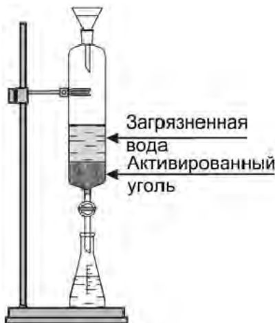
Рисунок 12. Установка для очистки воды адсорбцией
