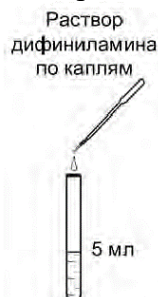
Рисунок 7. Обнаружение нитрат-ионов в исследуемой пробе воды
