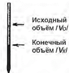
Рисунок 10. Определение израсходованного хлорида бария
