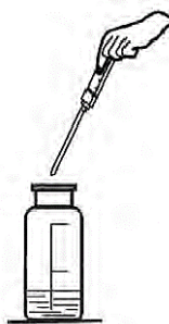
Рисунок 9. Соединение шприца-дозатора с пипеткой для титрования
