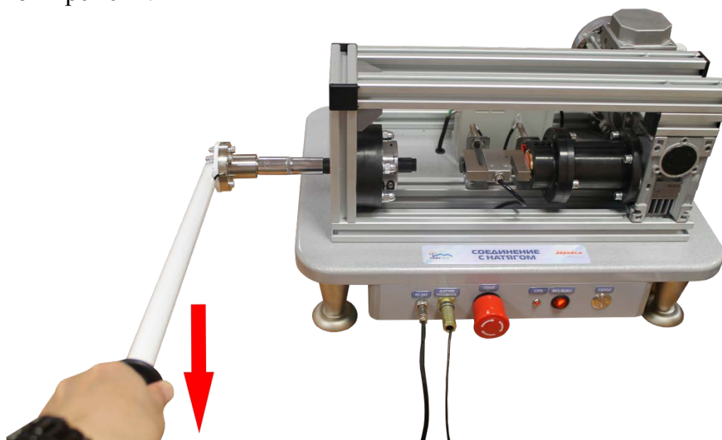
Рисунок 8. Испытание на относительный поворот.
