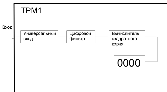
Рис. 3. Структурная схема прибора TPM1
