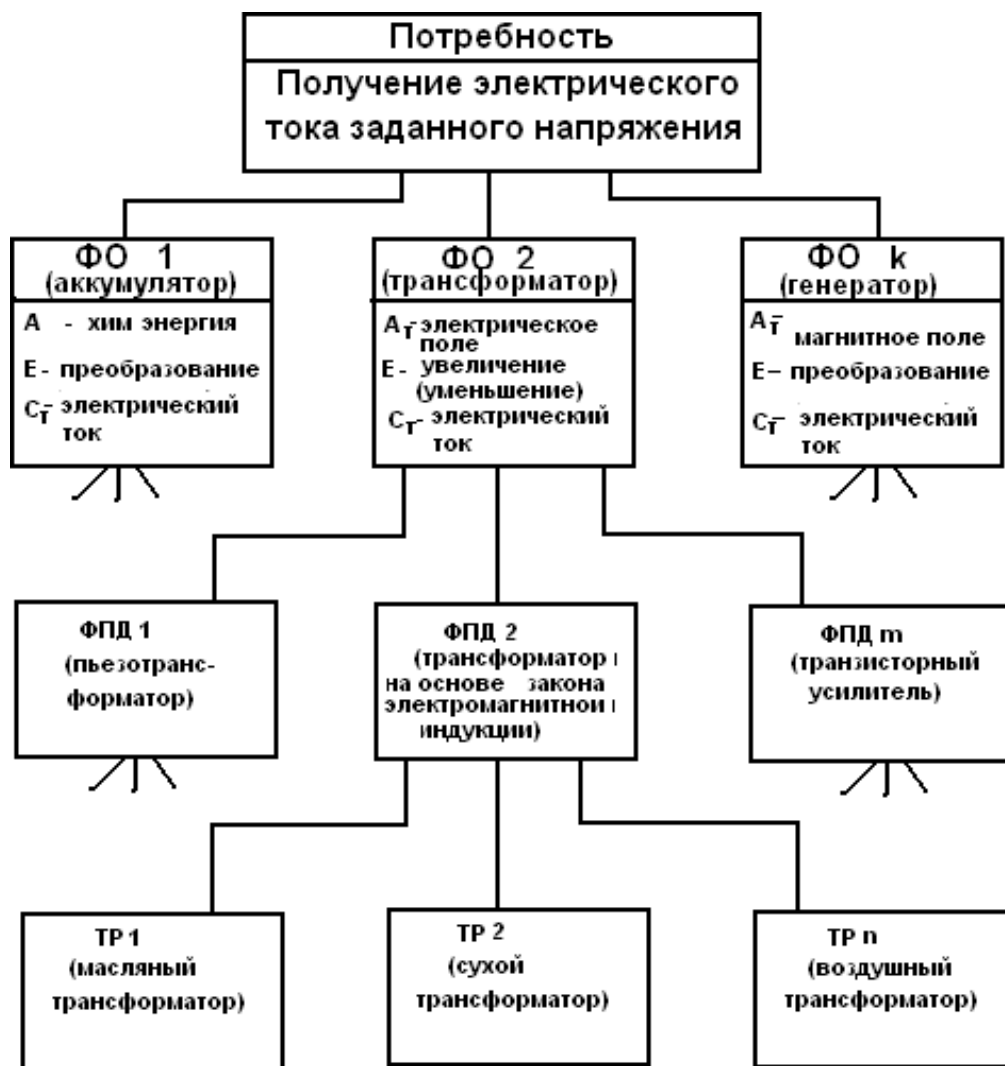
Рисунок 3 – Пример иерархии или систематики технического объекта
