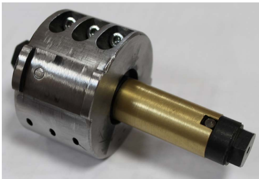
Рисунок 5. Установка вала во втулку перед запрессовкой
