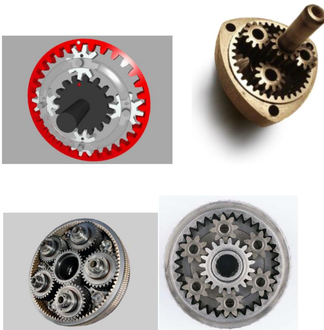
Рис. 2. Примеры планетарных механизмов
