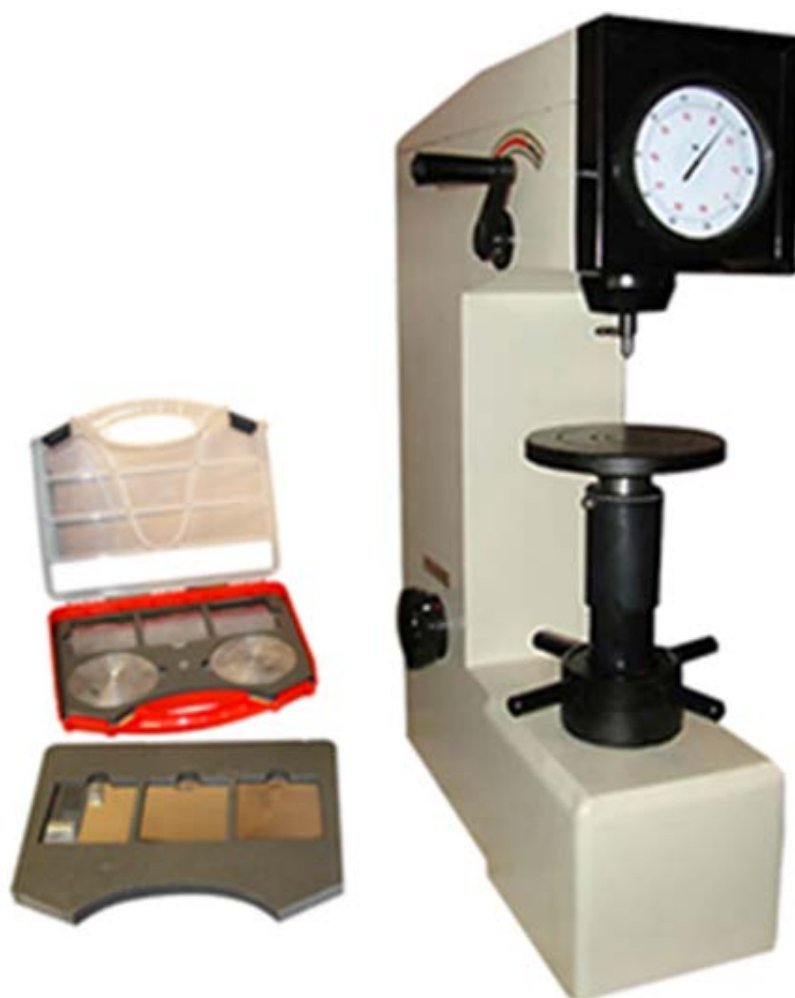
Рисунок 4.3 – Общий вид лабораторной установки для определения твёрдости по методу Роквелла.
