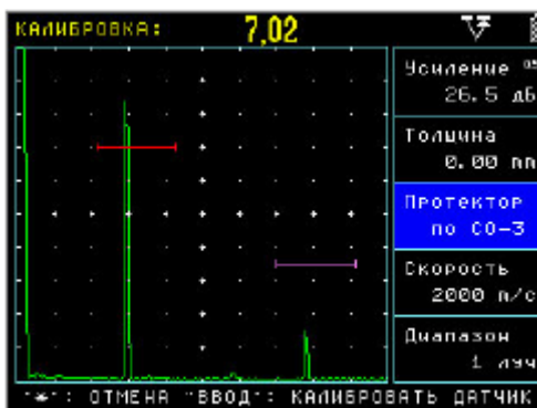
Рисунок 6.7 – Калибровка наклонного преобразователя по образцу СО-3
