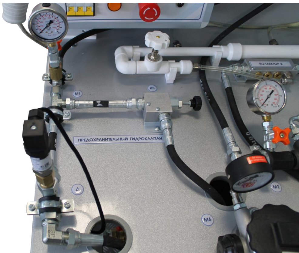
Рисунок 9 - Предохранительный гидроклапан, входная напорная магистраль
