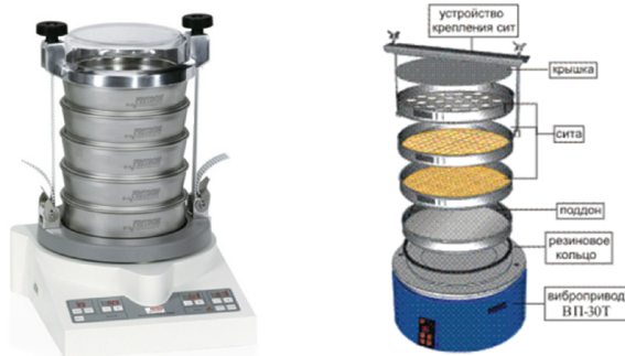
Рис. 2.1. Внешний вид и конструкция современного ситового анализатора.
