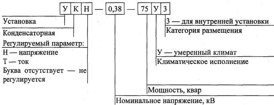
Рис. 8.1. Структурная схема условного обозначения компенсирующего устройства
