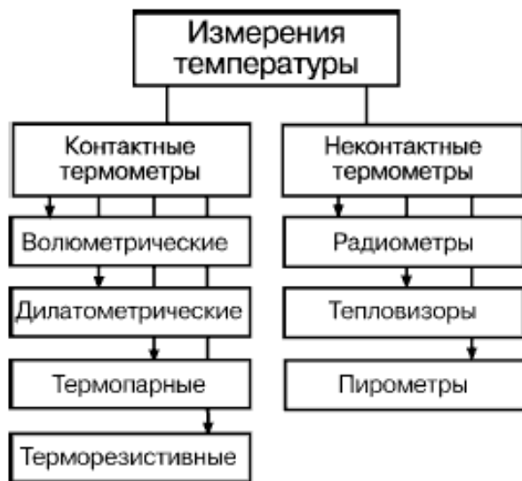
Рис.2.1. Классификация методов измерения температуры
