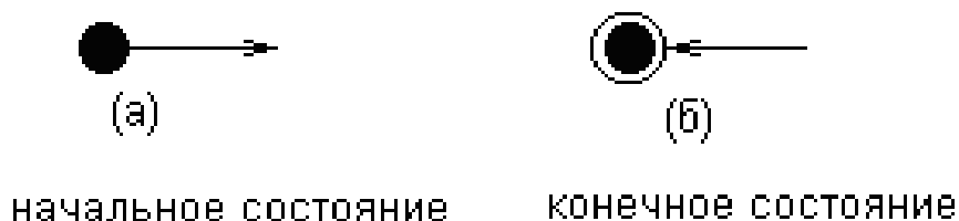
Рис. 32. Графическое отображение начального и конечного состояний на диаграмме состояний
