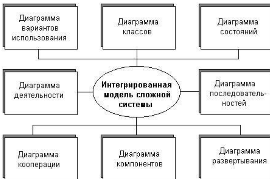
Рис. 16. Интегрированная модель сложной системы в нотации UML
