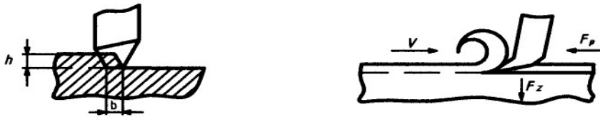
Рис. 4.2. Сечение срезаемого слоя при строгании
