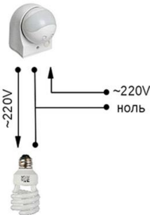
Рисунок 1. Схема подключения датчика движения
