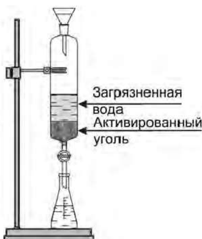
Рисунок 12. Установка для очистки воды адсорбцией
