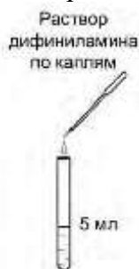
Рисунок 7. Обнаружение нитрат-ионов в исследуемой пробе воды
