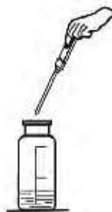
Рисунок 9. Соединение шприца-дозатора с пипеткой для титрования
