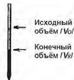
Рисунок 10. Определение израсходованного хлорида бария
