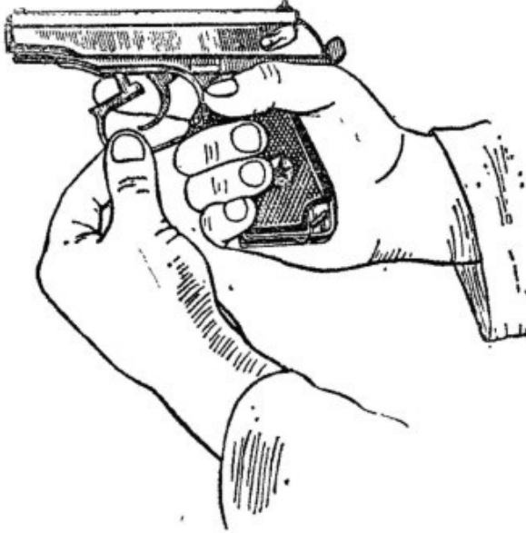
Рис. 4. Оттягивание спусковой скобы
