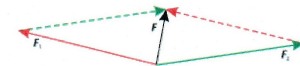
Рисунок 4.1 – Векторная сумма сил (параллелограмм сил)
