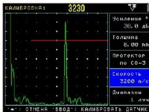
Рисунок 6.9 – Калибровка скорости в образце
