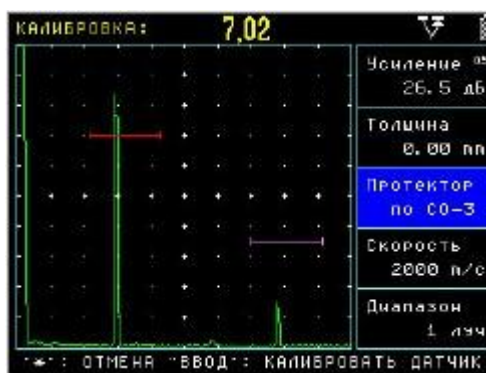
Рисунок 6.7 – Калибровка наклонного преобразователя по образцу СО-3
