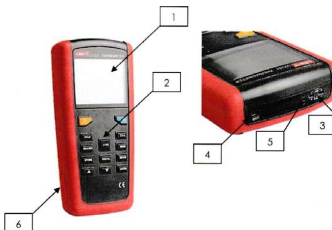
Рисунок 7.8 – цифровой быстродействующий термометр: 1 – дисплей; 2 – кнопки; 3 – термопара ввода T1; 4 – USB порт; 5 – NTC (компенсация нормальной температуры); 6 – батарейный отсек.
