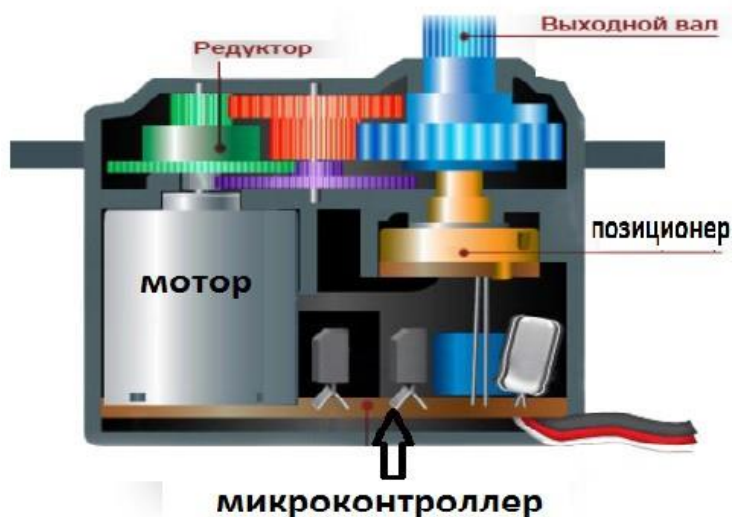
Рисунок 1 – Упрощенный вид сервопривода
