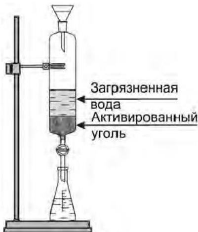
Рисунок 12. Установка для очистки воды адсорбцией
