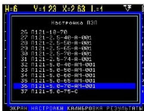
Рисунок 6.8 – Выбор стандартного преобразователя
