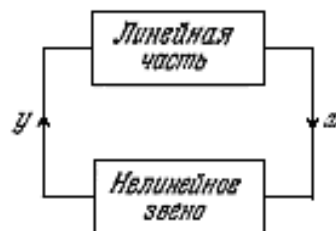
Рисунок 4.1.2 – Структурная схема нелинейной АСР
