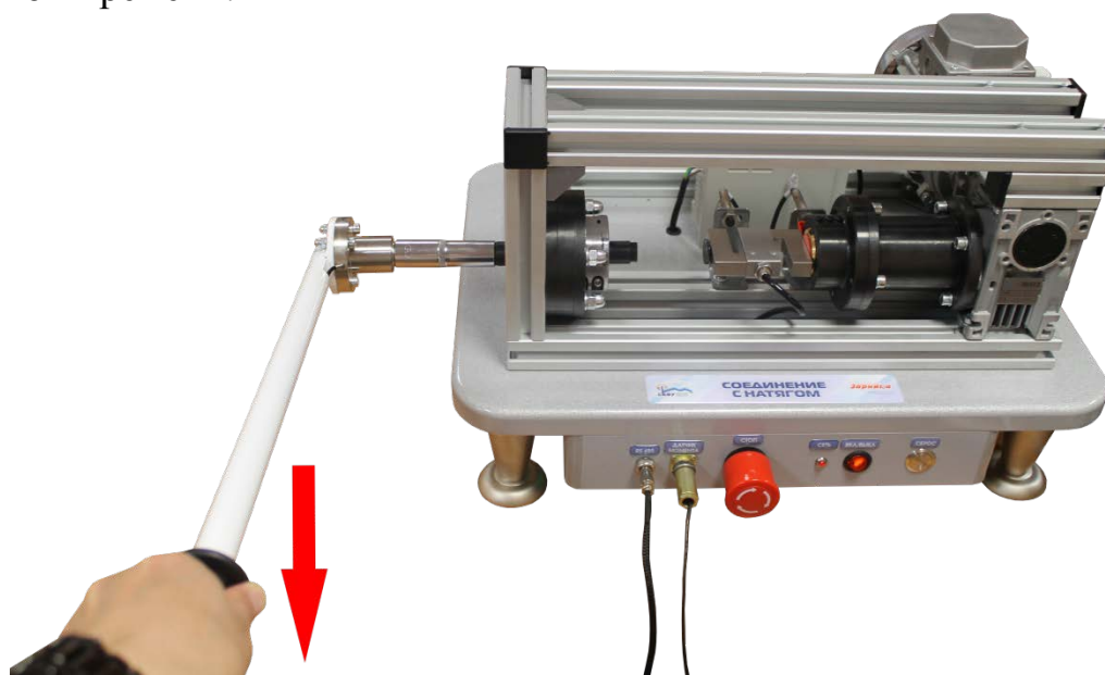
Рисунок 8. Испытание на относительный поворот.
