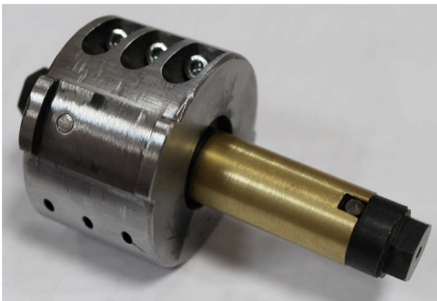
Рисунок 5. Установка вала во втулку перед запрессовкой
