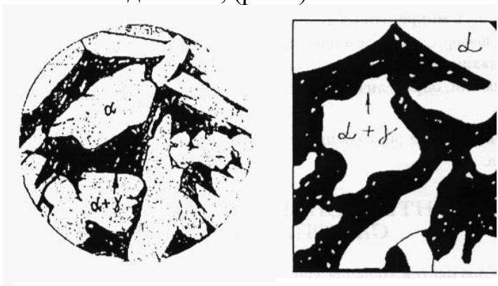
Рис. 5. Микроструктура литой двухфазной бронзы (справа -
