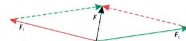
Рисунок 4.1 – Векторная сумма сил (параллелограмм сил)
