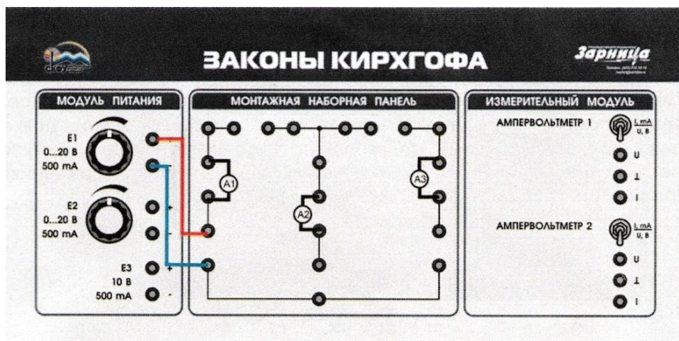
Рисунок 13.3 – Электрическая схема эксперимента
