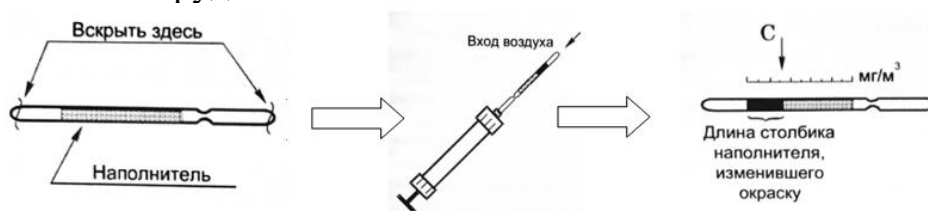
Рисунок 31. Схема определения концентрации диоксида углерода с помощью индикаторных трубок
