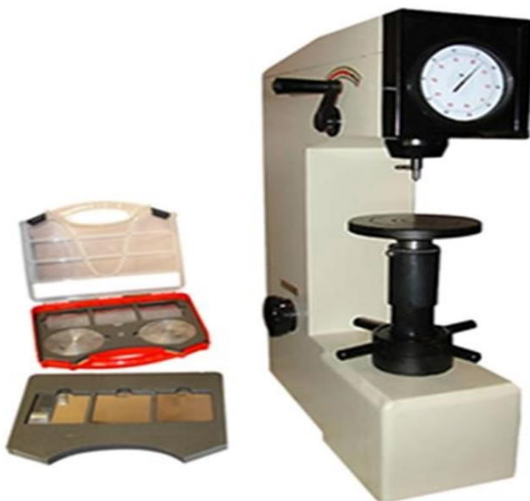
Рисунок 3 – Общий вид лабораторной установки для определения твердости по методу Роквелла
