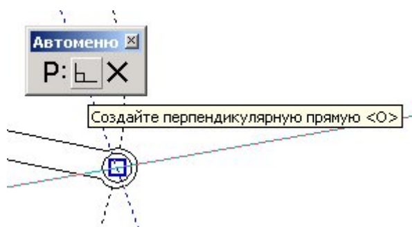
Рисунок 75 – Построение перпендикулярной прямой
