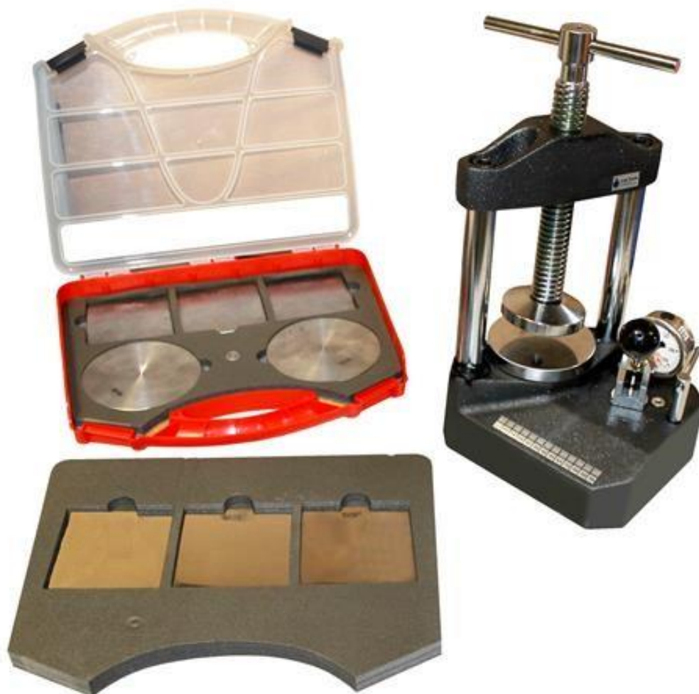
Рисунок 5.5 – Общий вид комплекта учебно-лабораторного оборудования «Исследование влияния холодной пластической деформации и последующего нагрева на микроструктуру и твердость низкоуглеродистой стали».
