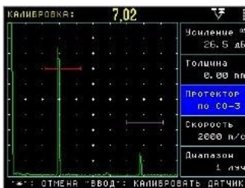
Рисунок 6.7 – Калибровка наклонного преобразователя по образцу СО-3
