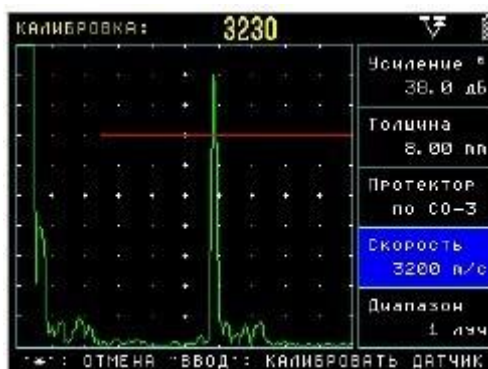
Рисунок 6.9 – Калибровка скорости в образце
