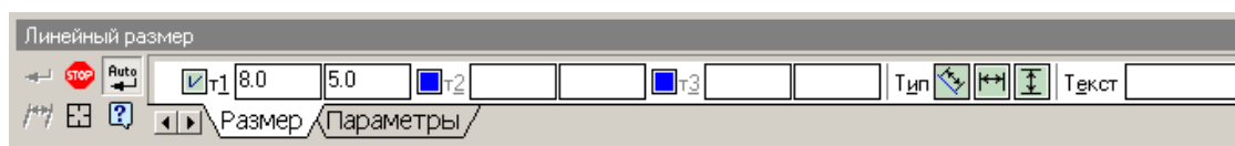
Рис. 2.7. Вид Панели свойств при нанесении линейных размеров
