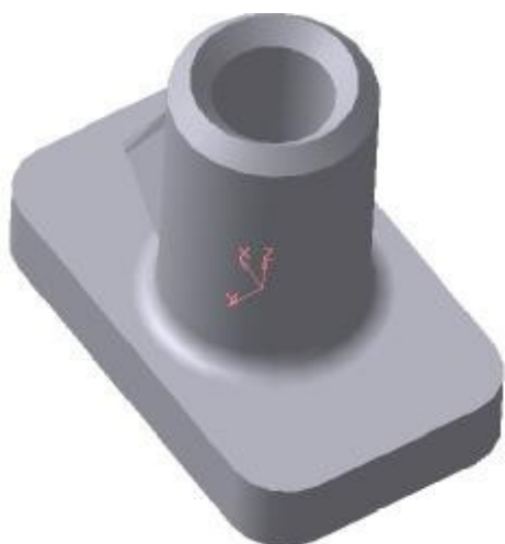
Рис. 7.3. Модель с выполненными скруглениями
