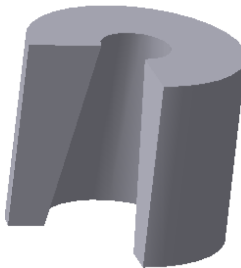
Рис. 7.12. Результат отсечения части модели по эскизу
