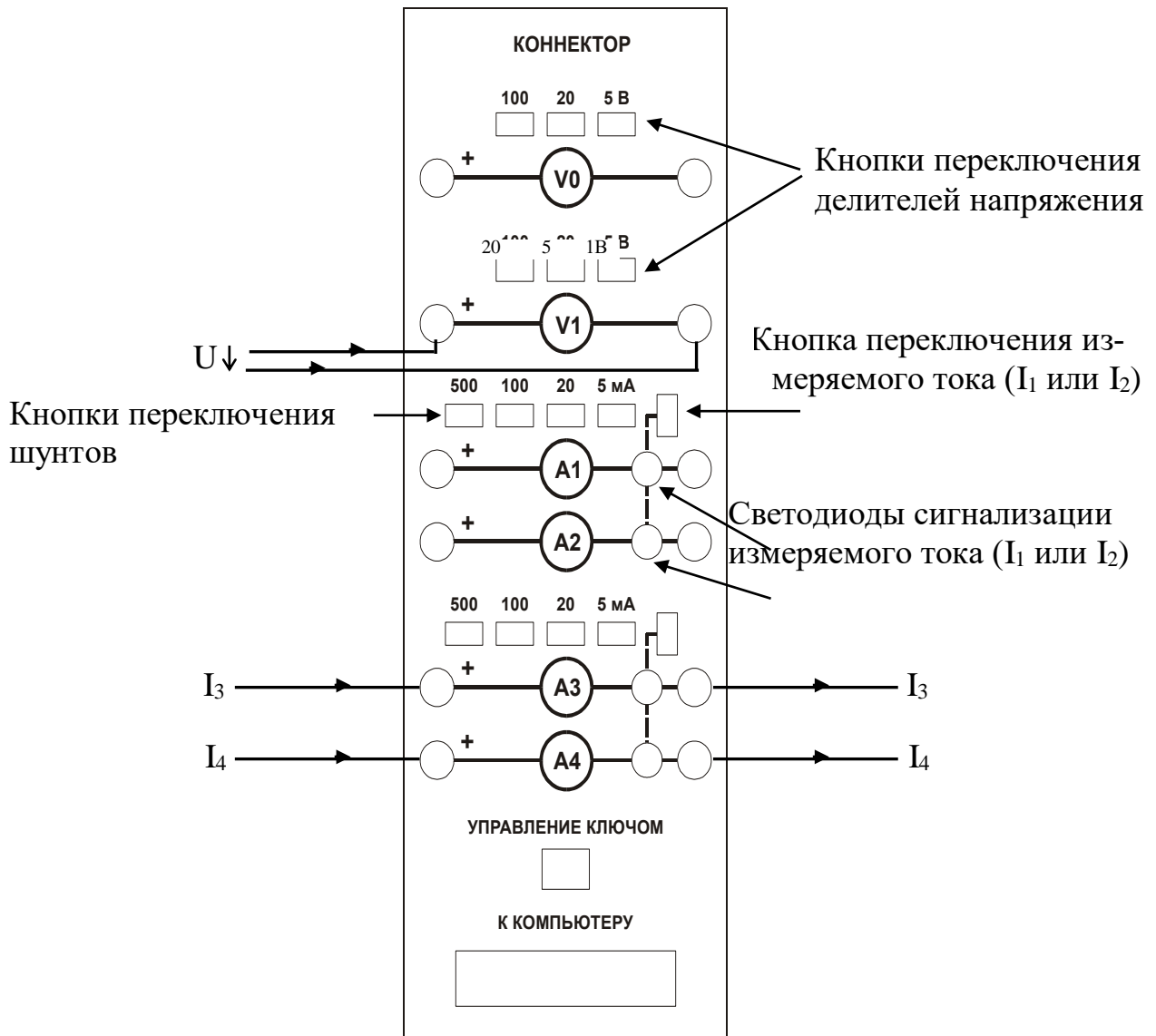
Рисунок 1 – Общий вид лицевой панели коннектора
