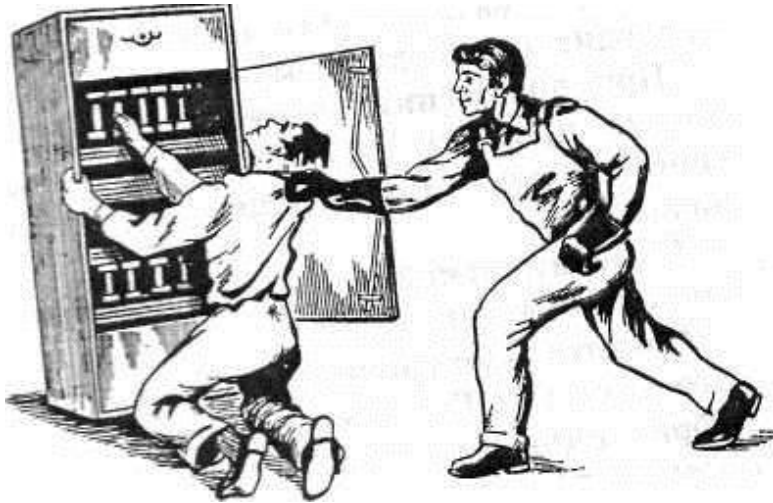
Рис. 1. Освобождение пострадавшего от действия электрического тока путем отключения электроустановки
