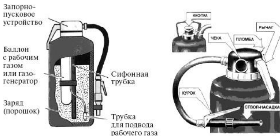
Рис. 26. Порошковый огнетушитель со встроенным газовым источником
