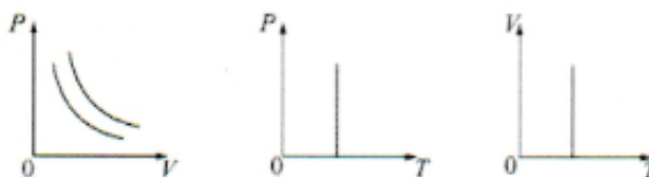
Рисунок 7.1 – Графики изотермического процесса.
