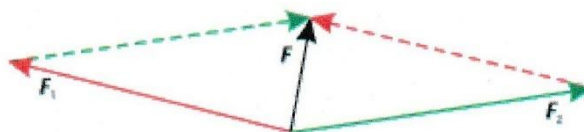
Рисунок 4.1 – Векторная сумма сил (параллелограмм сил)
