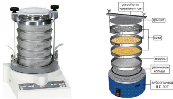
Рис. 2.1. Внешний вид и конструкция современного ситового анализатора.
