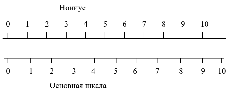
Рисунок 2.1 – Нониус и основная шкала
