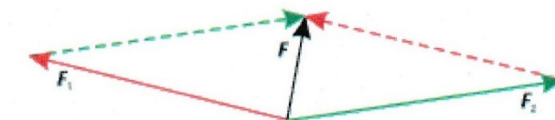
Рисунок 4.1 – Векторная сумма сил (параллелограмм сил)
