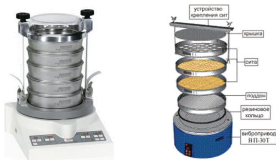
Рис. 2.1. Внешний вид и конструкция современного ситового анализатора.
