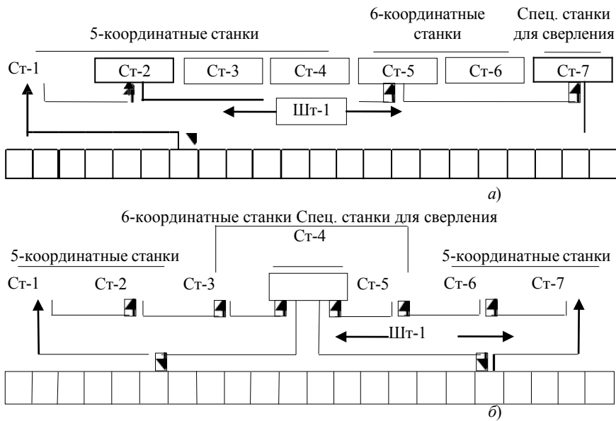
Рис. 3.7. Схемы расположения станочной системы ГПС и циклограммы работы штабелеров, сгруппированных по конструктивному признаку (а) и по типовому технологическому маршруту (б)
